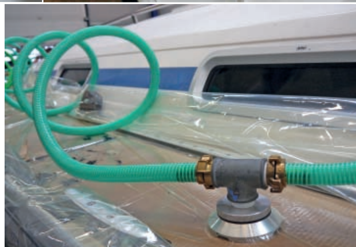
Die Laufdecks der Bavaria vor der Aktion. Links oben: Sikaflex als Klebstoff und (links) die Vorrichtung für die Vakuum-Verklebung. Geklebt und optimal: Teakdeck im Bugbereich (rechts).
