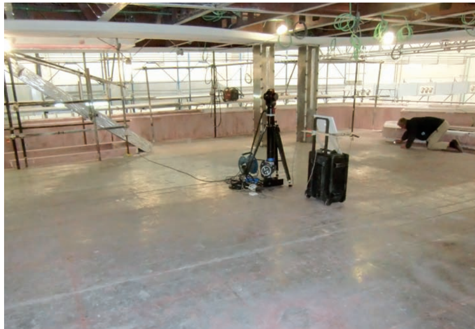
Ist-Aufnahme der Stahlsituation an Bord einer Mega-Yacht. Recording of the current steel situation on board of a mega-yacht.
