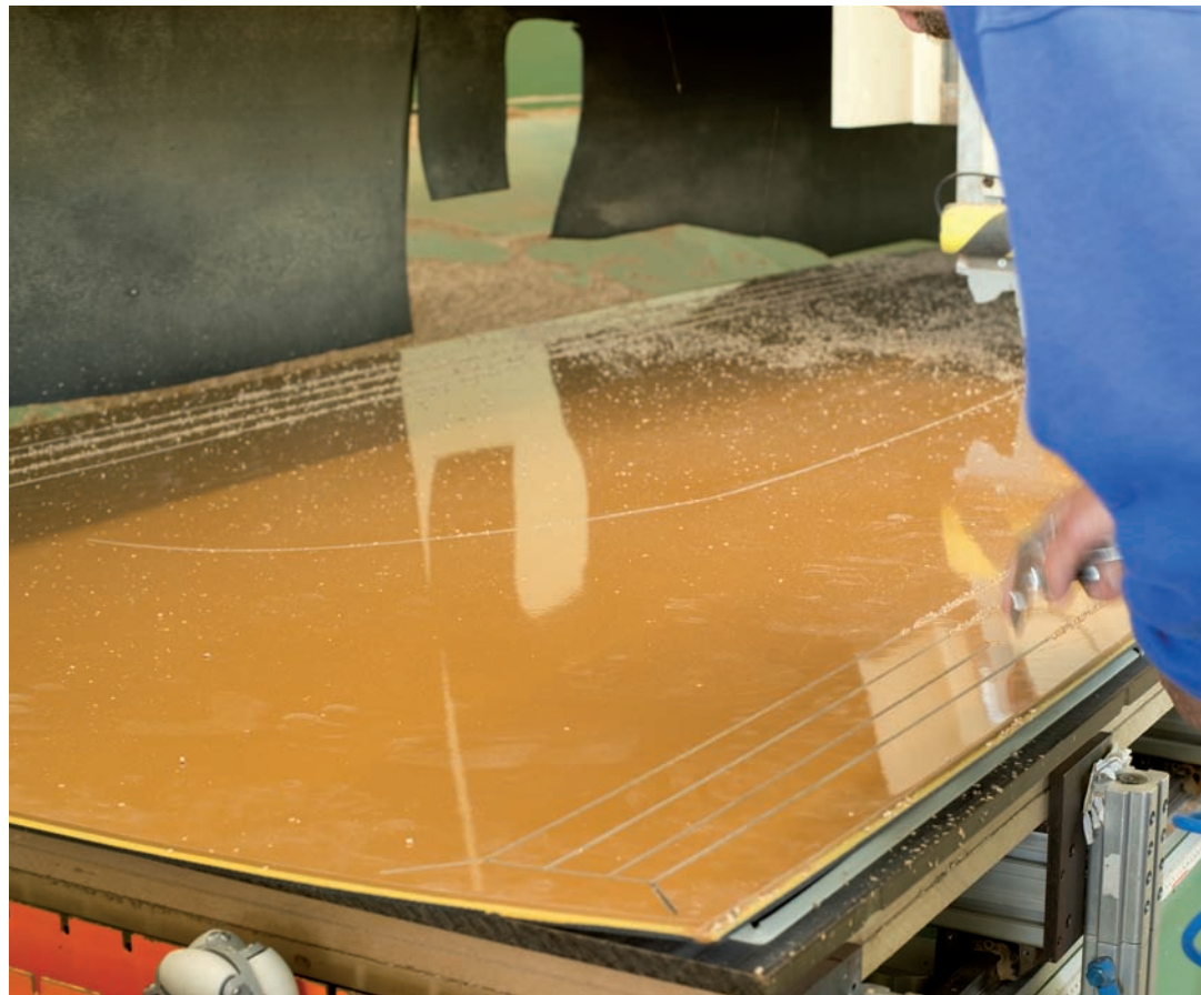
CNC-Bearbeitung der WOLZYNTEEK -Kunststoffpaneele nach dem innovativen Wolz Nautic Fertigungsprozess.
